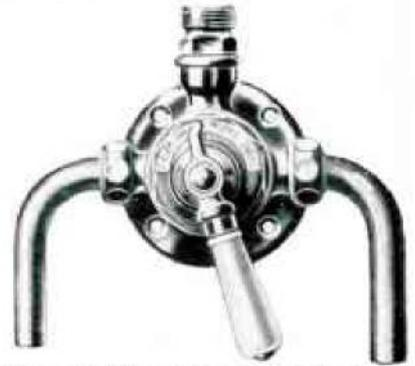
Fig. 476. — Robinet mélangeur pour douche donnant à volonté l'eau froide, l'eau mélangée ou l'eau chaude. Arrivées et départ 20×27
