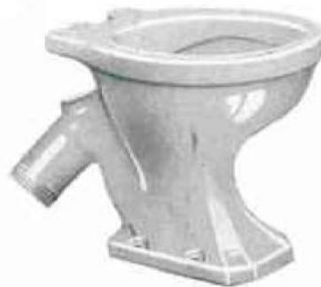
Fig. 306 L. - Cuvette avec siphon apparent pied-carré, sortie oblique. Poids : 11 kilog. Inclinaison de la sortie : 45°.
