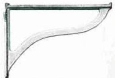
**Console de chauffe-bains avec taquet, éloignant le chauffe-bain du mur.**
