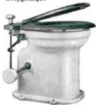
Closet "L'Hygiénique" fig. 507, avec ou sans effet d'eau, en porcelaine, avec clapet et mécanisme en cuivre niqué, bouton de tirage en porcelaine, siège abattant fixé sur la cuvette, façon acajou, acajou véritable, avec ou sans couvercle.
