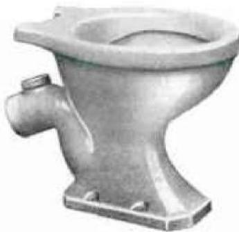
Fig. 306 O. - Cuvette avec siphon apparent sortie oblique à droite, à gauche ou arrière. Poids : 10 kil. Inclinaison de la sortie : 11°.
